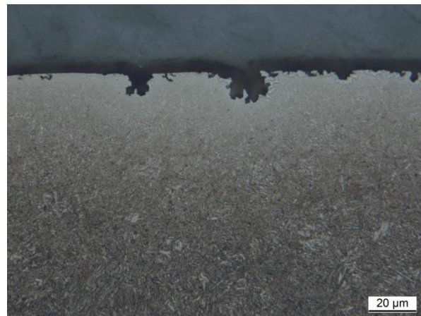
Bild 6: Schadteil – Substratoberfläche mit chemischen Angriff
